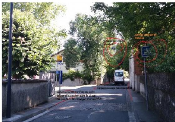
Le panneau de signalisation du ralentisseur n'est pas visible, il sera remplacé par un panneau de pré-signalisation situé plus en amont.
